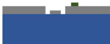
e) Spin PMMA, EBL, Deposit catalyst
